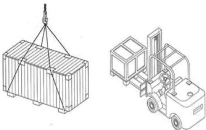
Поднятие упакованного сваереза с помощью троса или с помощью вилочного погрузчика. Разгрузка, поднятие и перенос оборудования выполняется квалифицированным персоналом с помощью подъемного оборудования.
